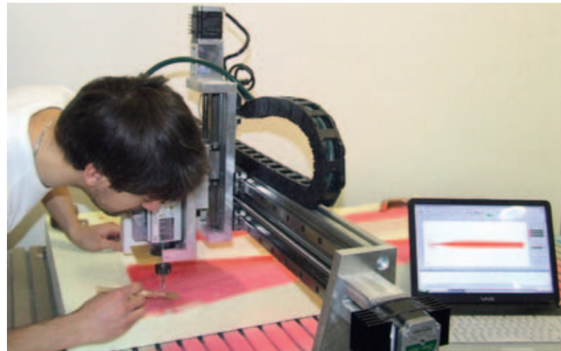
Stetige Kontrolle während des letzten Fein-Fräsvorgangs
