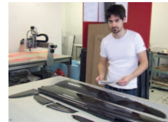
Nach dem Entformen der Modellteile müssen diese entgratet werden
