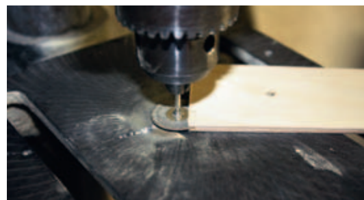
Beide Folienscharniere werden mit einer Schere rund zugeschnitten, damit sie in die mit einer Diamant-Trennscheibe gefrästen Schlitz passen
