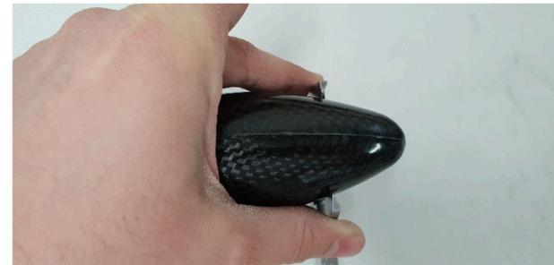
Mit einer Laubsäge oder einer Bandsäge die Spitze entfernen. Da man dies etwas entfernt von der fertigen Position macht hat man noch genügend Material für das Zuschleifen zu dem passenden Motorsturz und Seitenzug.
