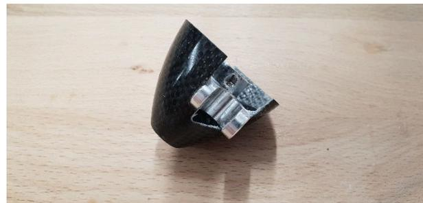
Nach dem Befestigen der Luftschraube und des Einfädels des Gummiringes testen ob die Blätter sich leichtgängig anlegen lassen und der Gummi nicht an einem Grat oder direkt am Carbon scheuert.
