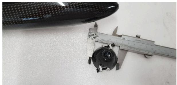
Der Messschieber wird am Rumpf angehalten und mit einer Säge ca. 4mm vor dem endgültigen Durchmesser markiert.
