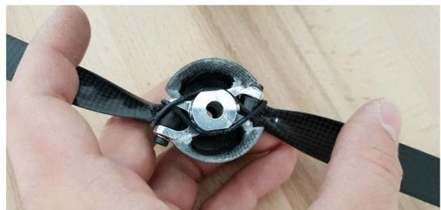
Ein Entgraten und leichtes Aufpolieren der Luftschrauben verlängert die Lebensdauer des Gummiringes deutlich. Bei jeder Klappbewegung gleitet dieser über die Fläche der Luftschrauben.
