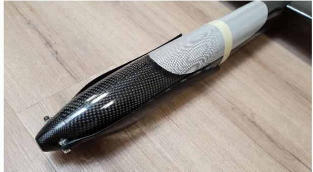
Für das Abschneiden der Rumpfspitze wird sicherheitshalber der Durchmesser des bestellten Spinners kontrolliert und mit dem Messschieber fixiert.
