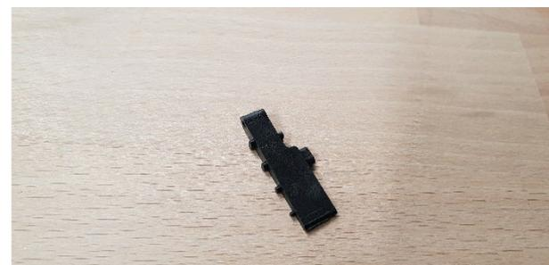
Zusätzlich empfehlen sich Bohrungen im hinteren Bereich der Lasche, mit z.B. einem 1.5mm Bohrer.
