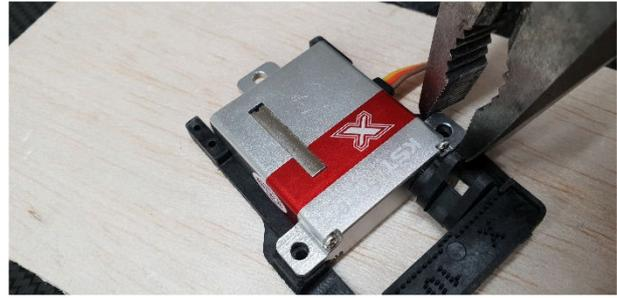
Grundsätzlich reicht die Verschraubung an den beiden gegenüberliegenden Laschen völlig aus, bei genügend Platz im Servoausschnitt kann auch die hintere Fixierung genutzt werden. Die Bohrung für die dritte Lasche ist am Kunststoffteil nicht mittig, auf die richtige Ausrichtung achten. Schrauben sorgsam und mit Gefühl anziehen, Schraubenkopf nicht beschädigen.
