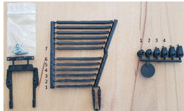
Das Ruderhorn ist zweiteilig ausgeführt und sollte für den Einbau bearbeitet werden. Dies kann mit einem Cutter, Schleifpapier oder an einer Säge bearbeitet werden. Um den Ausschnitt im Ruder minimal zu halten werden die äußeren Erhebungen entfernt. Damit die Schubstange deutlich weiter gedreht werden kann wird die innere Erhebung entfernt.
