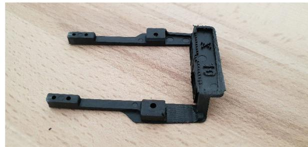
Am Servohebel befindet sich ab und zu ein kleiner Überstand, dieser verhindert je nach Größe das vollständige Aufschieben auf den Servoantrieb. Diesen mit einem Cutter flächig abziehen.
