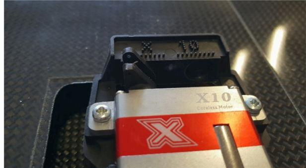
Der Servohebel sollte leicht erwärmt werden damit ein Aufpressen in den meisten Fällen überhaupt möglich ist. Dies kann z.B. in einem Ofen oder unter einer Glühbirne geschehen.
