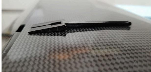
Zum Überprüfen der gesamten Anlenkung diese vorab einbauen und ausrichten. Sollte nun die Schubstangenlänge, die Ausfräsungen, die Ausrichtung des Servohebels usw. nicht passen diese leicht nacharbeiten oder austauschen. Nach der Verklebung kann das Ruderhorn und die Schubstange nur noch ausgefräst werden.
