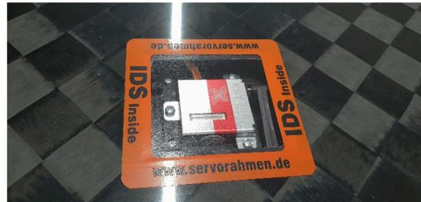
Bei der Verwendung der mitgelieferten Carbonabdeckung kann diese einfach mit einem Tesaband angeklebt werden. Hierzu das Tesaband mit Überlänge rasch abziehen, dies verhindert Schlieren in den meisten Klebebändern. Sorgfältig blasenfrei und Schritt für Schritt aufrubbeln. Sind alle vier Streifen aufgebracht mit einem scharfen Cutter an den Kanten ansetzen und das Band über die Klinge abziehen.
