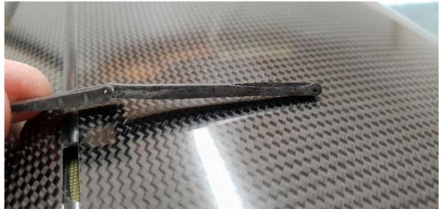
Am Servorahmen diverse überstehende Kanten abziehen. Die hervorstehende Versteifungsrippe an der Ruderseite mit z.B. einem Frässtift und zum Ruder hin auslaufend auf nahe null entfernen.
