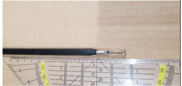
Zum Einhängen des Gabelkopfes den Pendelhebel in diese Stellung siehe Bild bringen. Den Gabelkopf von unten nach oben schieben und in dieser Position das Höhenruder halten.
