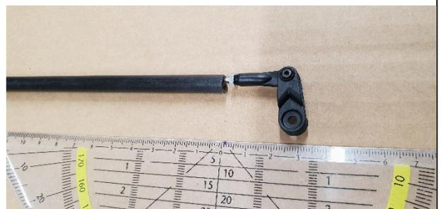
Für die Länge des Rohres das Höhenruder am Rumpf aufschieben und den empfohlenen Winkel zur Tragfläche einrichten. Hiermit hat man dann die exakte Position der Bohrung für den Gabelkopf am Pendelhebel und somit den Abstand zur Servoabtriebsmitte.
