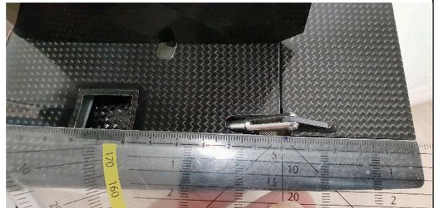
Im Bild zu sehen ist das fertige hintere Gestänge für die Seite mit einer Umwicklung aus Carbonroving für eine gute Steifigkeit und Formhaltigkeit. Dies geschieht erst sobald das Gestänge sauber für eine gute Leichtgängigkeit gebogen ist.
