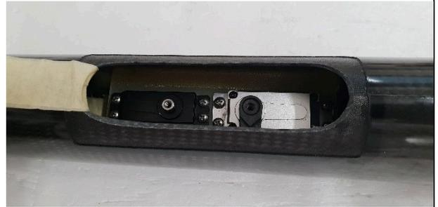
Nun werden die Anlenkungen gefertigt; für eine dauerhaft unproblematische Anlenkung haben sich Carbonrohre bewährt. Beim Pace VX3.8 sind dies zwei Carbonrohre mit einem Außendurchmesser von 8mm und einem Innendurchmesser von 6mm.
