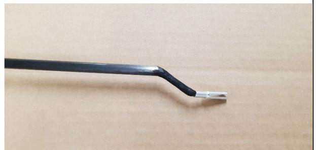
Das Gestänge mehrmals einhängen und nachbiegen bis dies leichtgängig funktioniert und gute Ausschläge erreicht werden. Dies kann mehrere Versuche benötigen :-)
