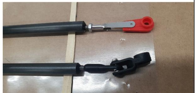
Zum Justieren für eine gute Nullposition ein paar Millimeter Spiel lassen, d.h. nicht direkt an das Rohr den Gabelkopf oder diese Kombination von Gabriel-Stahlformenbau ansetzen.
