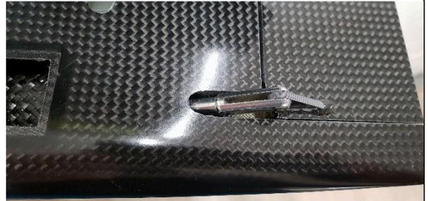
Für das Ruderhorn in die linke Seitenruderfläche einen ca. 2.5mm breiten Schlitz fräsen sodass gerade das Ruderhorn Platz findet.
