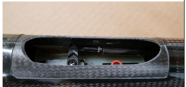
Das Seitenruder wird mit einem 8mm Carbonrohr, einer 3mm Edelstahlgewindestange und einem Alugabelkopf angelenkt.
